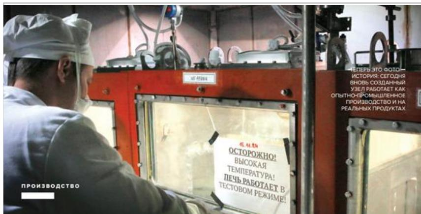
На ГХК заработало новое опытно-промышленное производство: первый диоксид америция получен на вновь созданном узле и успешно прошёл паспортизацию. Диоксид америция – перспективный ядерный материал, который выделяется из нецелевых технологических растворов, образующихся при переочистке плутония. Он всегда считался отходом, но теперь будет приносить пользу, став основой для развития новых направлений и производств на ГХК.
