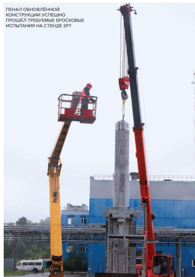
ПЕНАЛ ОБНОВЛЁННОЙ КОНСТРУКЦИИ УСПЕШНО ПРОШЕЛ ТРЕБУЕМЫЕ БРОСКОВЫЕ ИСПЫТАНИЯ НА СТЕНДЕ ЗРТ
