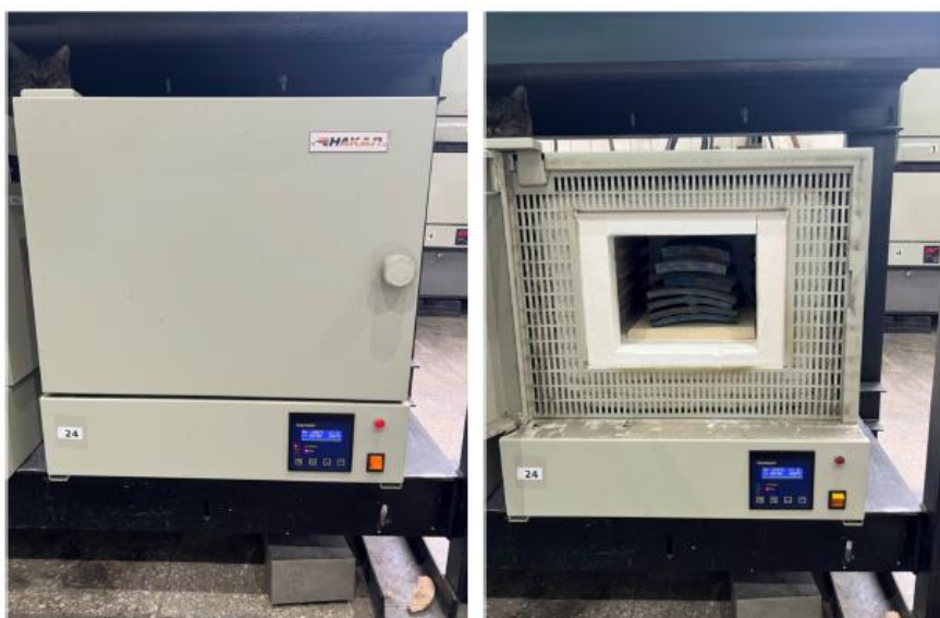
Общий вид печей для проведения ускоренного термического старения образцов
