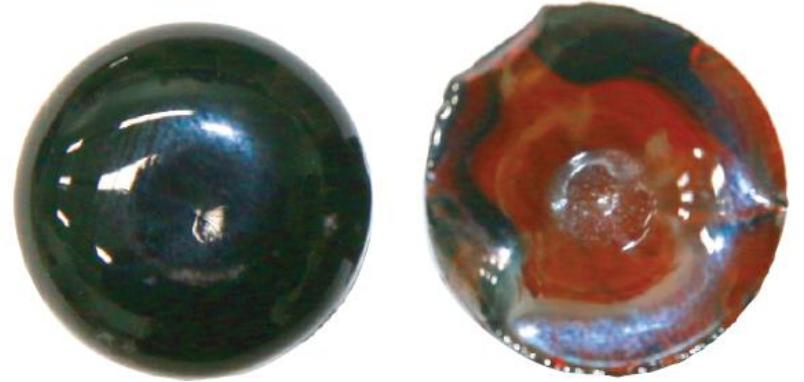
ОПЫТНЫЕ ОБРАЗЦЫ С ВКЛЮЧЕНИЕМ В МАТРИЦУ БОРОСИЛИКАТНОГО СТЕКЛА (НА ИМИТАТОРЕ) СЛЕВА — СО СТРОНЦИЕМ, СПРАВА — С ЦЕЗИЕМ И КАРБОНАТОМ СТРОНЦИЯ
