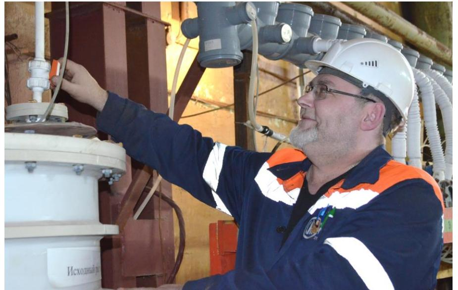
соединённых между собой ячеек, внутри которых переливается специальный рабочий раствор. Из него с помощью специального реагента постепенно извлекаются нужные элементы.
